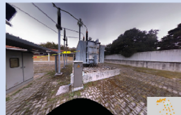
Ambiente di navigazione delle immagini sferiche catturate in fase di rilievo con possibilità di eseguire misurazioni ad alta precisione sfruttando la sovrapposizione tra nuvola di punti ed immagini
